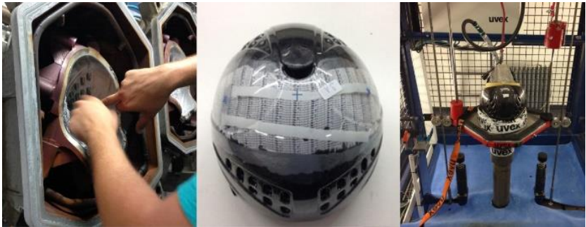
Links: Herstellungsprozess eines bionischen Helms bei der Firma Uvex. Mitte: bionischer, faserverstärkter Helm. Rechts: Testvorrichtung zum normierten Testen von Helmen.
