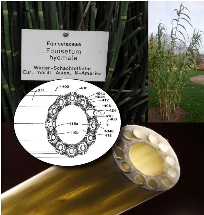
Oben links: Winterschachtelhalm ( Equisetum hyemale ). Oben rechts: Pfahlrohr ( Arundo donax ). Mitte: Patentzeichnung des Technischen Pflanzenhalms. Unten: Technischer Pflanzenhalm.
